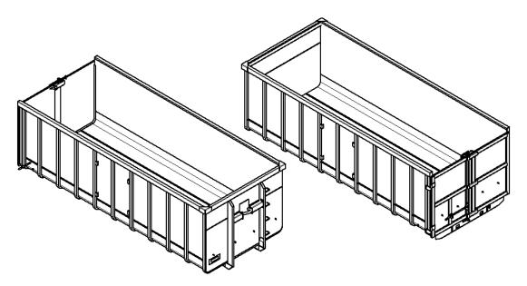
LINHA TPR - FABRICADO EM AÇO SAE 1020 COM CHASSI EM VIGA U LAMINADA DE 8", FECHADA COM REFORÇOS; FUNDO EM CHAPA #8 (4,25 mm) E LATERAIS EM CHAPA #12 (2,65 mm), COSTELAS EM CHAPA #8 (4,25 mm); VARÃO DE FECHAMENTO DAS PORTAS EM 1.1/8" DE DIÂMETRO; FAIXAS REFLETIVAS;
