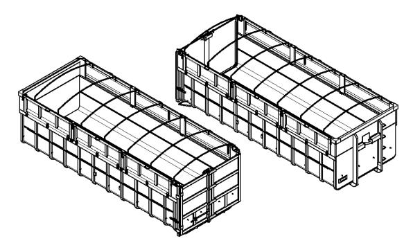
LINHA TP – FABRICADO EM AÇO SAE 1020 COM CHASSI EM VIGA U LAMINADA DE 8", FECHADA COM REFORÇOS; FUNDO E LATERAIS EM CHAPA #12 (2,65 mm), COSTELAS EM CHAPA #8 (4,25 mm); VARÃO DE FECHAMENTO DAS PORTAS EM 1.1/8" DE DIÂMETRO; FAIXAS REFLETIVAS;
