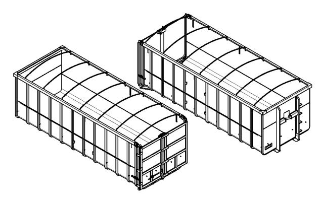
LINHA TP — FABRICADO EM AÇO SAE 1020 COM CHASSI EM VIGA U LAMINADA DE 8", FECHADA COM REFORÇOS; FUNDO E LATERAIS EM CHAPA #12 (2,65 mm), COSTELAS EM CHAPA #8 (4,25 mm); VARÃO DE FECHAMENTO DAS PORTAS EM 1.1/8" DE DIÂMETRO; FAIXAS REFLETIVAS;
