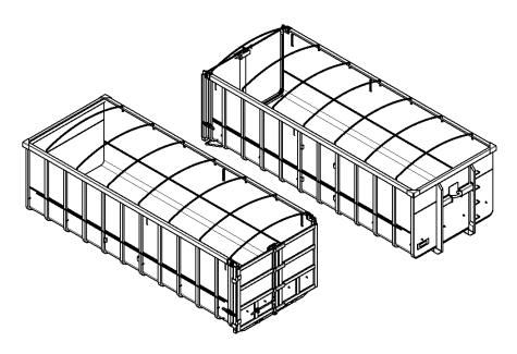
**LINHA TP** – FABRICADO EM AÇO SAE 1020 COM CHASSI EM VIGA U LAMINADA DE 8", FECHADA COM REFORÇOS; FUNDO E LATERAIS EM CHAPA #12 (2,65 mm), COSTELAS EM CHAPA #8 (4,25 mm); VARÃO DE FECHAMENTO DAS PORTAS EM 1.1/8" DE DIÂMETRO; FAIXAS REFLETIVAS;
