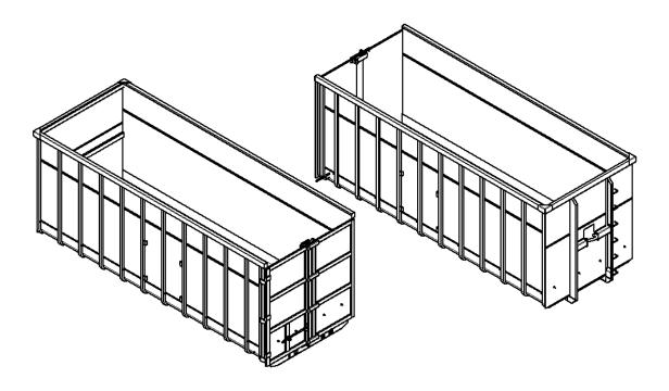
LINHA TPR - FABRICADO EM AÇO SAE 1020 COM CHASSI EM VIGA U LAMINADA DE 8", FECHADA COM REFORÇOS; FUNDO EM CHAPA #8 (4,25 mm) E LATERAIS EM CHAPA #12 (2,65 mm), COSTELAS EM CHAPA #8 (4,25 mm); VARÃO DE FECHAMENTO DAS PORTAS EM 1.1/8" DE DIÂMETRO; FAIXAS REFLETIVAS;
