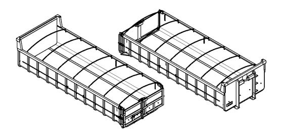
LINHA TPR - FABRICADO EM AÇO SAE 1020 COM CHASSI EM VIGA U LAMINADA DE 8", FECHADA COM REFORÇOS; FUNDO EM CHAPA #8 (4,25 mm) E LATERAIS EM CHAPA #12 (2,65 mm), COSTELAS EM CHAPA #8 (4,25 mm); VARÃO DE FECHAMENTO DAS PORTAS EM 1.1/8" DE DIÂMETRO; FAIXAS REFLETIVAS;
