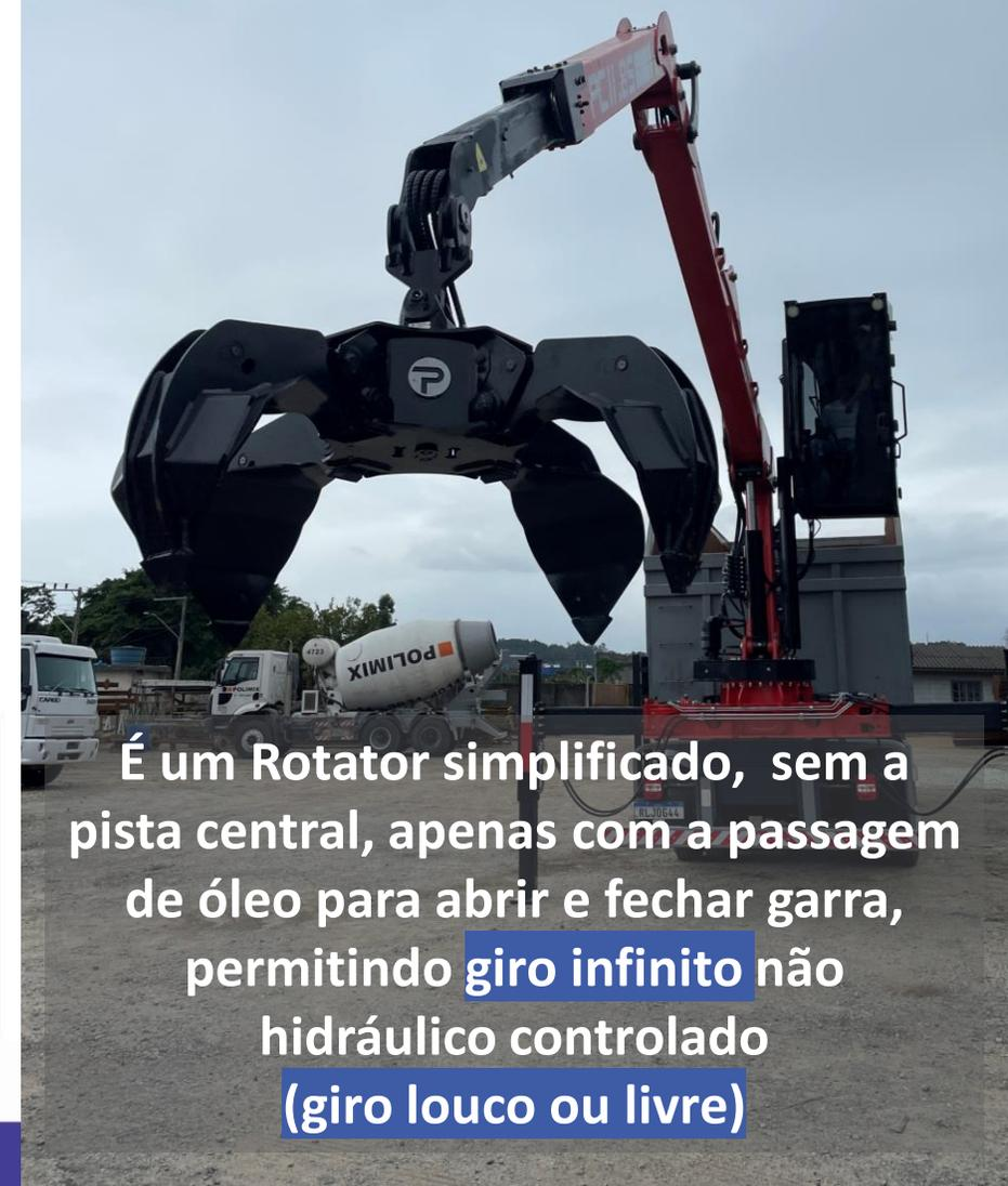
É um Rotator simplificado, sem a pista central, apenas com a passagem de óleo para abrir e fechar garra, permitindo giro infinito não hidráulico controlado (giro louco ou livre)
